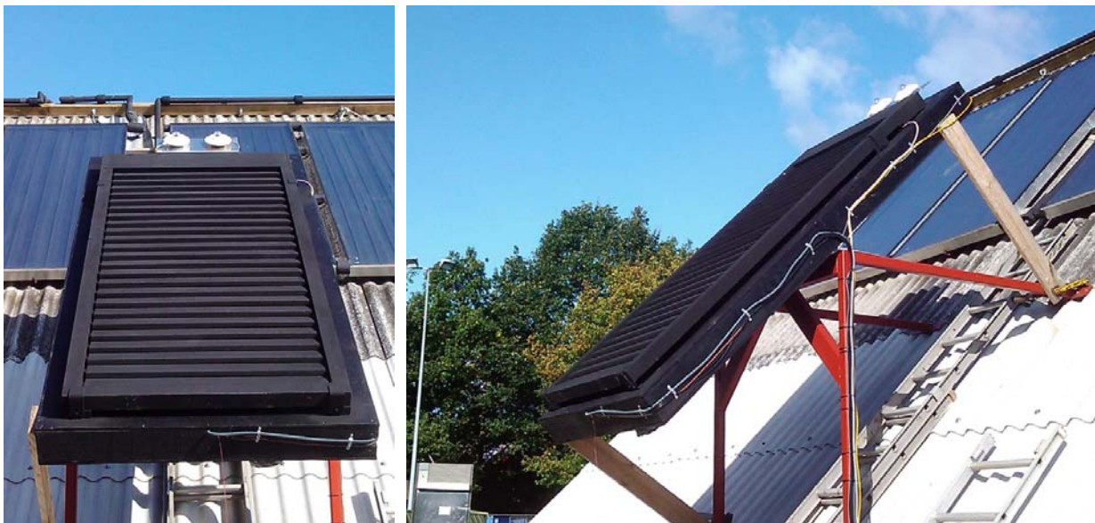
Figur 2. Billeder af energisolfangeren fra Venetian Solar ApS monteret på DTU Byg's luftsolfangerprøvestand.
