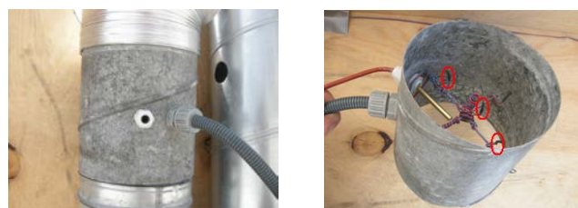
Figur 5. Luftkanal med temperaturfølere. Termoelementtråd type TT er anvendt til temperaturmålinger. Temperaturføleren PT 100 til højre i figuren anvendes til temperaturkorrektion af volumenstrømmen.
